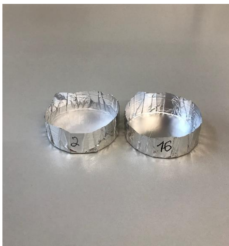
9 pav. 12,57 cm 2 folijos lėkštelės pavyzdys (16) ir folijos lėkštelės su polimerine plėvele pavyzdys (2)
