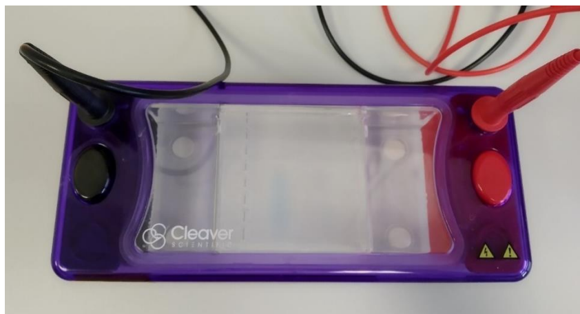
20 pav. Elektroforezės vonelė su agarozės geliu. Juodas elektrodas – katodas, raudonas – anodas. Neigiamai įkrautos molekulės juda teigiamai įkrauto anodo link (iš kairės į dešinę)
