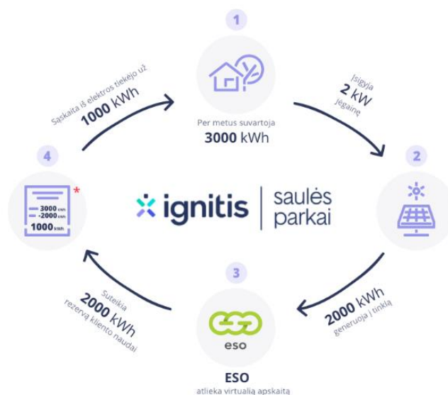
16 pav. Nutolusių saulės elektrinių pagamintos energijos apskaitymo schema
