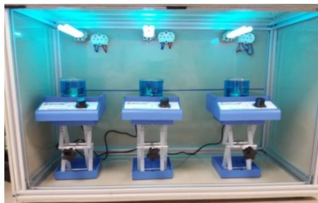
16 pav. Fotokatalizatorių tyrimų stendas ir jo schema
