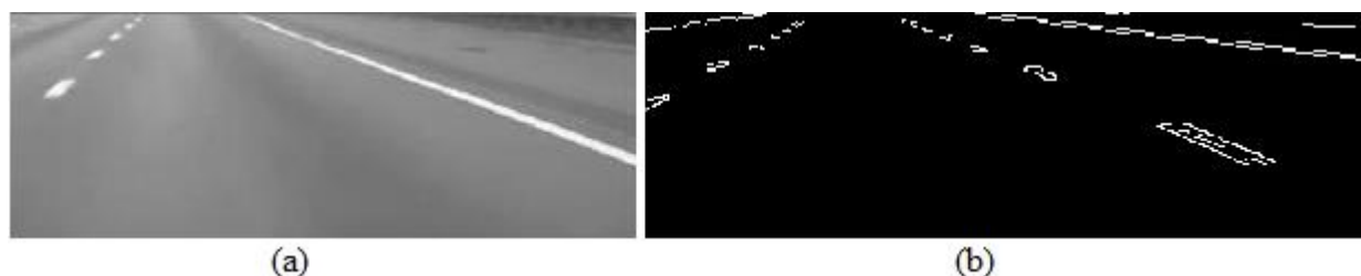
1.2 pav. Canny briaunų aptikimo algoritmo veikimo pavyzdys (a) originalus nespalvotas vaizdas (b) Canny algoritmo apdorotas vaizdas su aptiktomis briaunomis [1]
