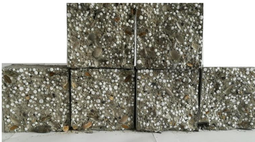
2 pav. Pastato pamato su EPS granulių priedu pavyzdys [20]
