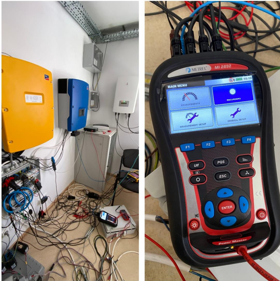
10 pav. “Metrel” MI2892 tinklo analizatorius, dirbantis prie saulės elektrinės tinklo[28]
