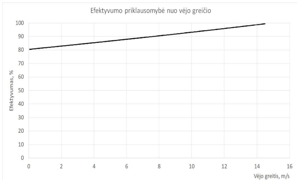
22 pav. Saulės elektrinės inverterio efektyvumo priklausomybė nuo vėjo greičio
