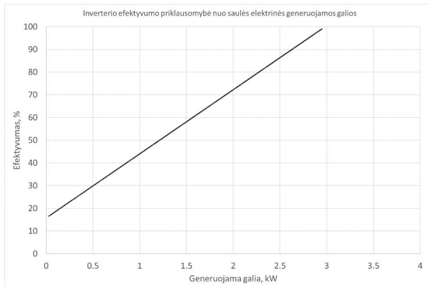
27 pav. “Ginlong” inverterio GCI-5K-H efektyvumo priklausomybė nuo saulės elektrinės generuojamos galios
