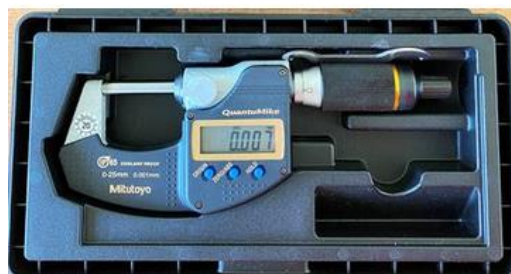
13 pav. Skaitmeninis mikrometras QuantuMike IP65
