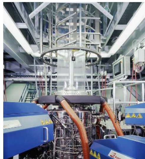
7 pav. Principinė plėvelės gamybos ekstrudiniu pūtimo būdu schema ir pavyzdys [30]
