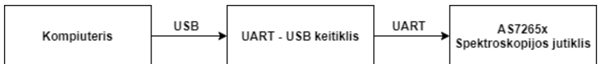
2.9 pav. Spektroskopijos jutiklio AS7265x prijungimo prie personalinio kompiuterio struktūrinė schema
