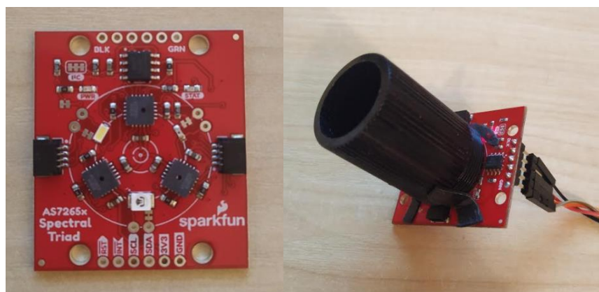
2.10 pav. AS7265x spektroskopijos jutiklis. Kairėje – be apsauginio cilindru, dešinėje – su apsauginiu cilindru.
