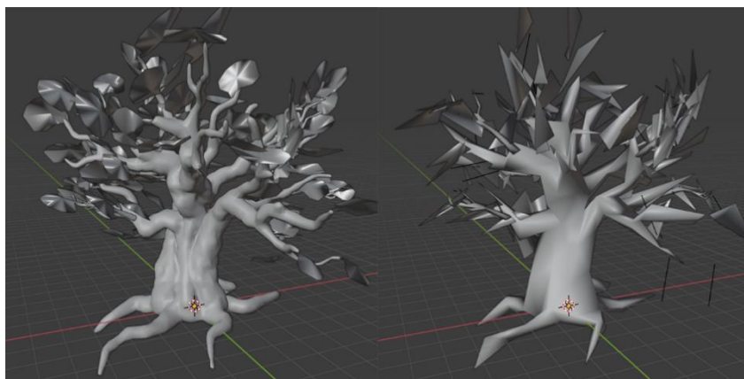
3.1 pav. Trimatis modelis skirtingu detalumo lygiu: kairėje – didelis (20878 trikampiai), dešinėje – mažas (929 trikampiai)
