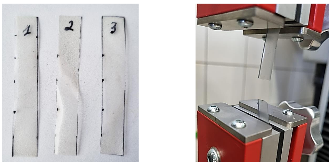
2.9 pav. Bandiniai mechaninėms savybėms ištirti bei tempimo procesas
