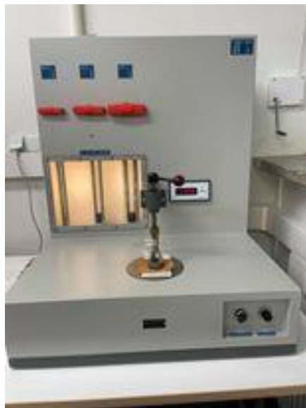
12 pav. L14DR laidumo orui matavimo prietaisas
