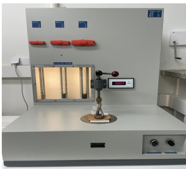
7 pav. Laidumo orui matavimo prietaisas
