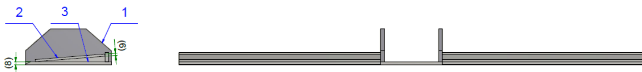
1.18 pav. Žertuvo sparno bloko susidėvimimo schema, 1 – žertuvo sparno rėmas, 2 – žertuvo sparno viršutinė plokštelė, 3 – žertuvo sparno apatinė plokštelė
