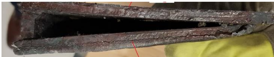
1.21 pav. Žertuvo sparno lūžimas dėl netinkamo suvirinimo
