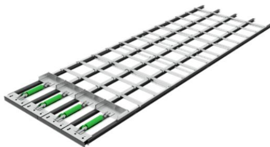
1.10 pav. UAB „Enerstena“ kuro sandėliavimo ir tiekimo sistema [13]
