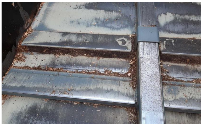
1.23 pav. Sušalusio kuro dalelės po platformų žertuvų sparnais
