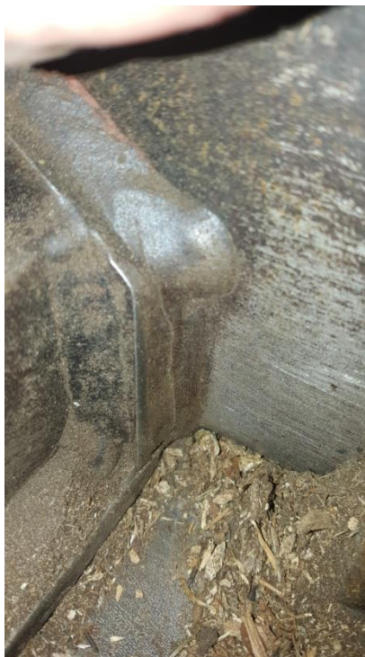
2.1 pav. Matomas suvirinimo siūlės trūkis
