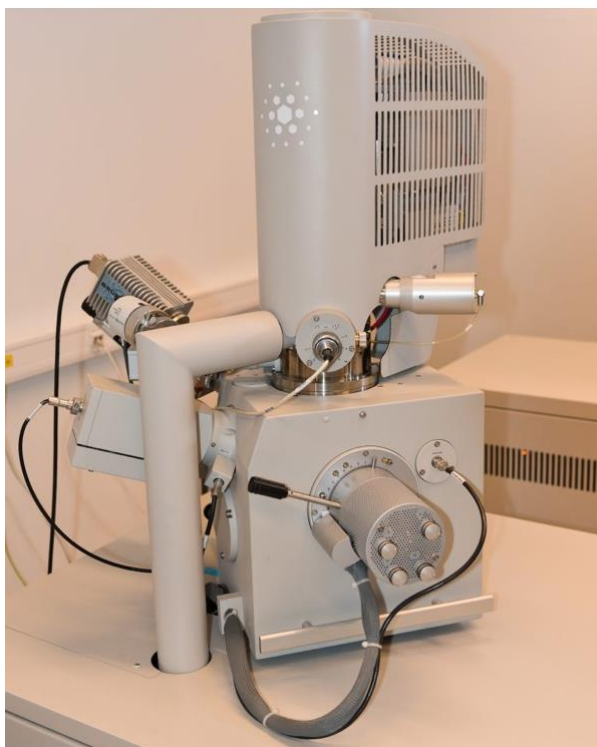
14 pav. Skenuojantis elektroninis mikroskopas FEI Quanta 200 FEG [42].
