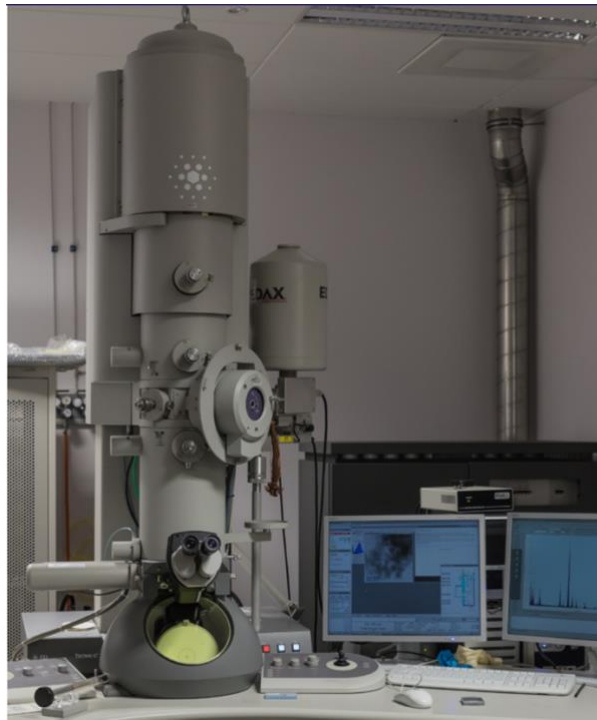
15 pav. Peršviečiamasis elektroninis mikroskopas FEI Tecnai G20 [50].
