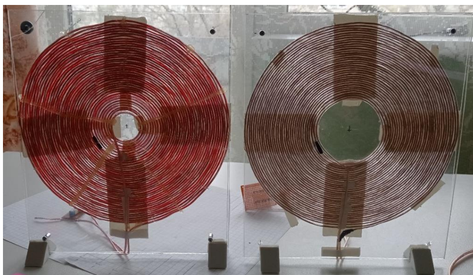
37 pav. Pagamintos imtuvo (kairėje) ir siūstuvo (dešinėje) induktyviosios ritės
