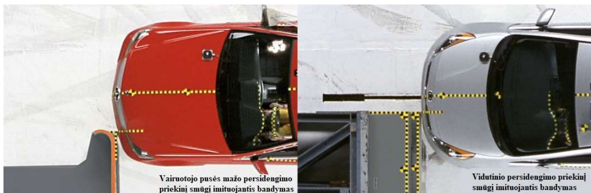
1 pav. Mažo persidengimo (kairėje) ir vidutinio persidengimo (dešinėje) priekinį smūgį imituojantys bandymai [2]
