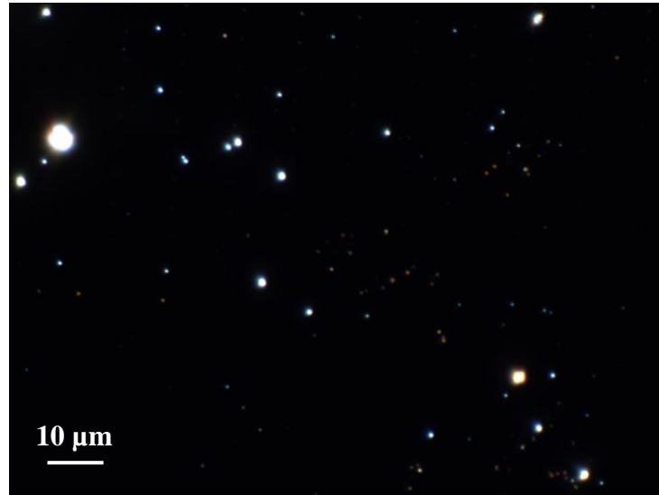
1 pav. DLC:Ag dangos paviršiaus tamsaus lauko nuotrauka padaryta optiniu mikroskopu (objektyvo didinimas 100x). Skirtingos spalvos matomos dėl nevienodų dalelių spindulių
