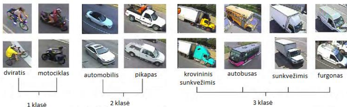
5 pav. Transporto klasifikavimas į klases pagal aptiktus parametrus [7]
