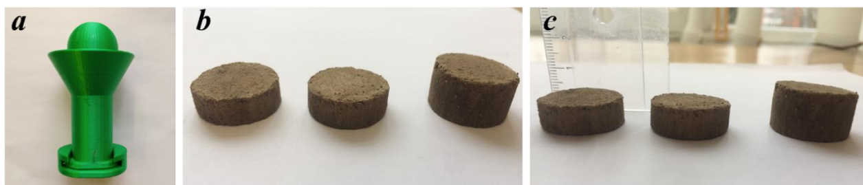
2.21 pav. 3D spausdintuvu atspausdinta forma (ekstruderis) (a) ir kavos tirščių ir grikių lukštų pelenų tabletės (b ir c)
