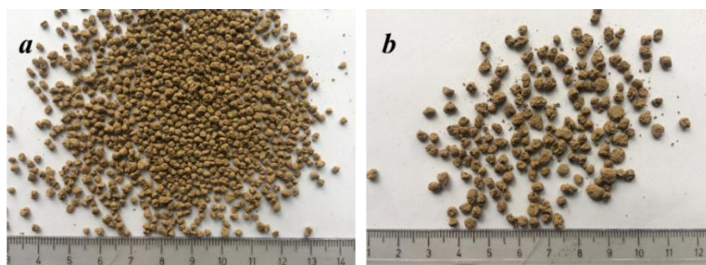
2.13 pav. Produktas, gautas granuliuojant KT:SP = 1:4 santykiu, drėkinimui naudojant 40 % melasos tirpalą 21 % ortofosforo rūgšties tirpale: a – dalelių dydis 2–3 mm; b – dalelių dydis 3–5 mm
