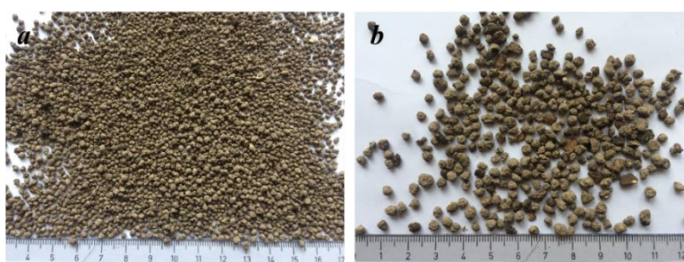
2.17 pav. Produktas, gautas granuliuojant DKT:GLP = 1:4 santykiu su 60 % returo, drėkinimui naudojant 40 % melasos tirpalą 21 % ortofosforo rūgšties tirpale: a – dalelių dydis 2–3 mm; b – dalelių dydis 3–5 mm
