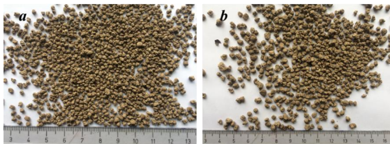
2.11 pav. Produktas, gautas granuliuojant KT:GLP = 1:4 santykiu, drėkinimui naudojant 40 % melasos tirpalą 21 % ortofosforo rūgšties tirpale: a – dalelių dydis 2–3 mm; b – dalelių dydis 3–5 mm
