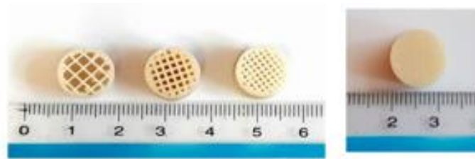
1.13 pav. Atspausdintos atviros sistemos tabletės su 25 %, 50 %, 75 % užpildu ir uždaros sistemos tabletė. Iš kairės į dešinę [25]
