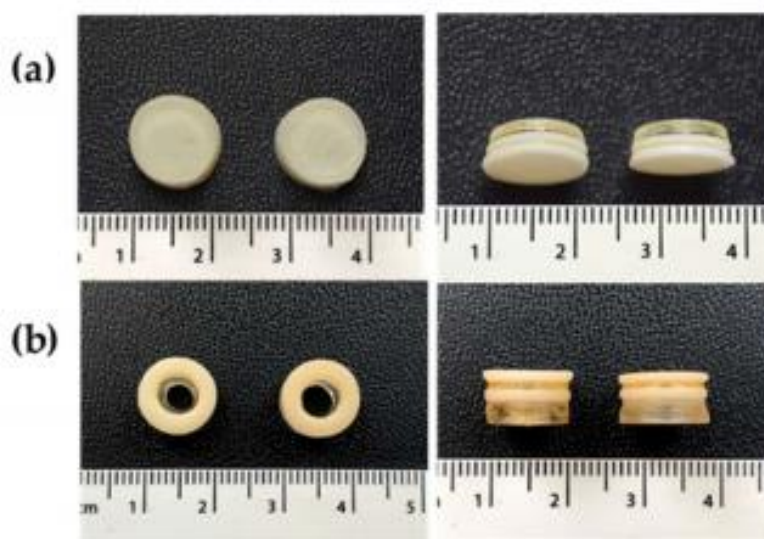
1.11 pav. Atspausdintos daugiafunkcinės tabletės, (a) cilindro forma (b) žiedo forma [40]
