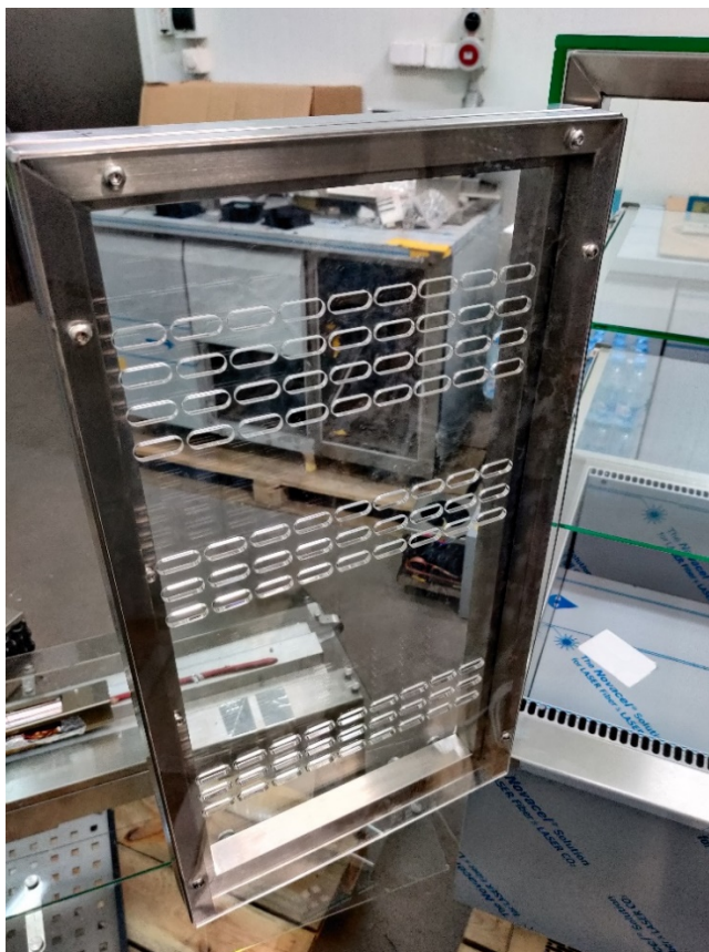
2.4 pav. Tiriamojoje šaldymo vitrinoje su šaldoma vonia naudojamų durelių konstrukcija
