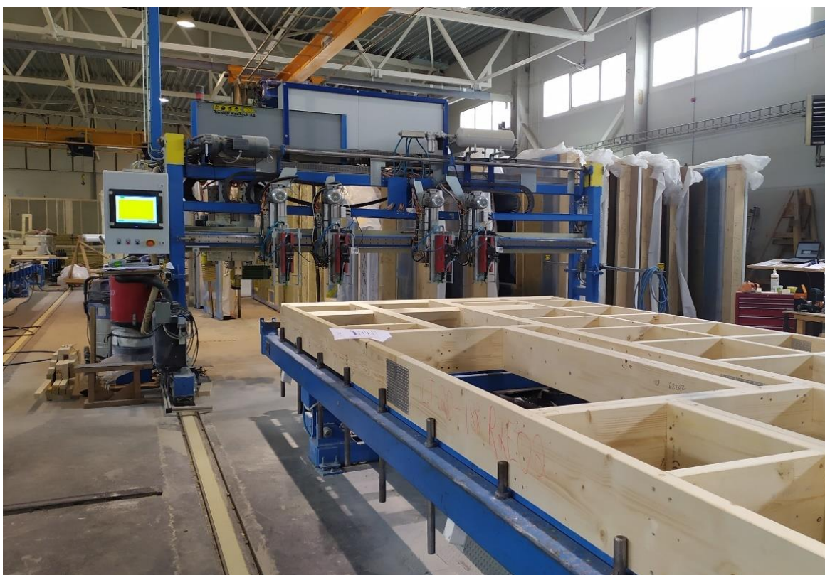
1 pav. Automatinė sienų panelių kalimo linija
