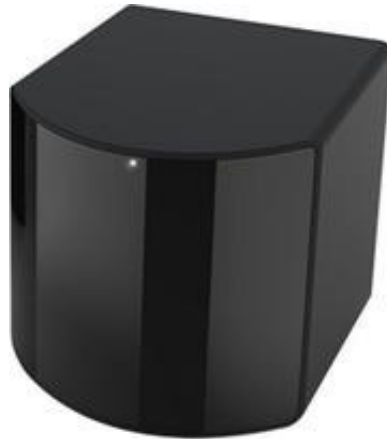
2.2 pav. Outside-in optinio judesio sekimu paremta HTC Vive Base Station 2.0 infraraudonos šviesos spindulių kamera
