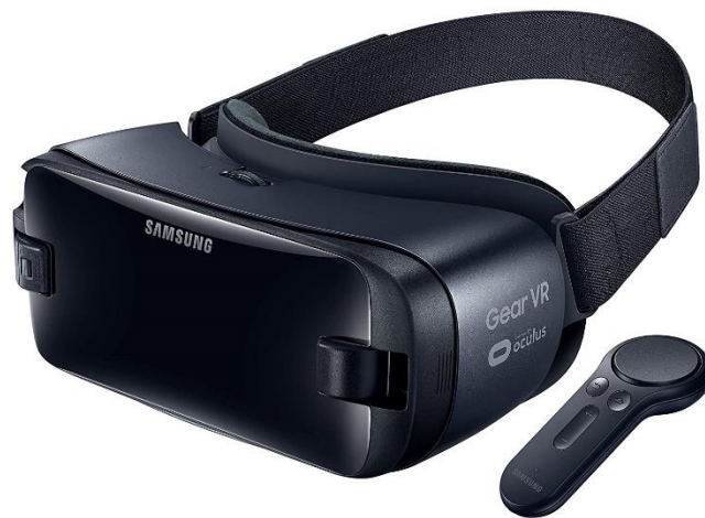
2.1 pav. Inercinį judesio sekimo būdą naudojantys Samsung Gear VR akiniai ir valdiklis
