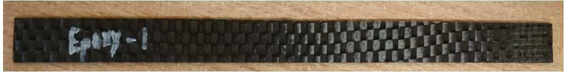
Fig. 27. CFRP Tensile test specimen
