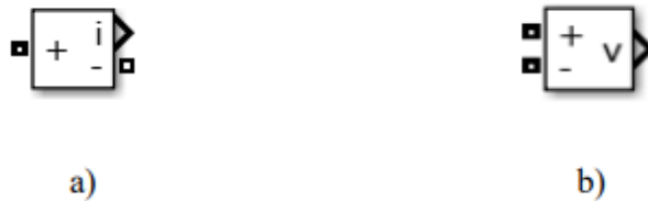
32 pav. Simulink matavimo blokai panaudoti efektnių verčių nustatymui. a) „Current measurement“ blokas srovės matavimui. b) „Voltage measurement“ blokas įtampos matavimui.[11]
