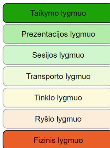
1.5 pav. OSI modelio struktūra
