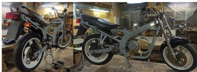
3.26 pav. Motociklo bendras vaizdas surinkus mechaninius komponentus.
