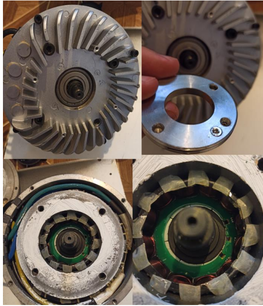
3.3 pav. Variklio konstrukcija atsukus galinį variklio dangtį.
