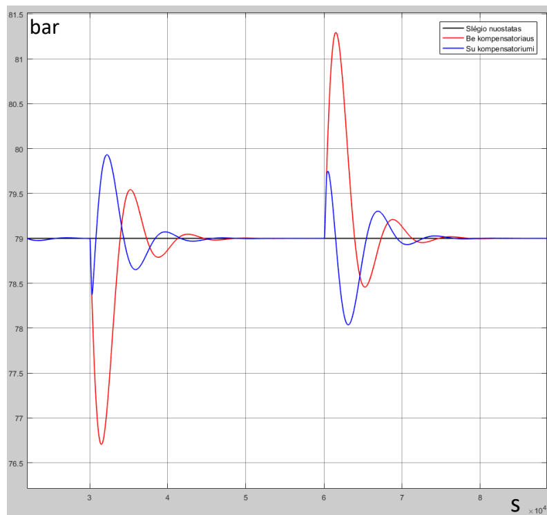
46 pav. Slėgio palaikymas diskrečiuoju PID regulatoriumi su ir be kompensatoriaus
