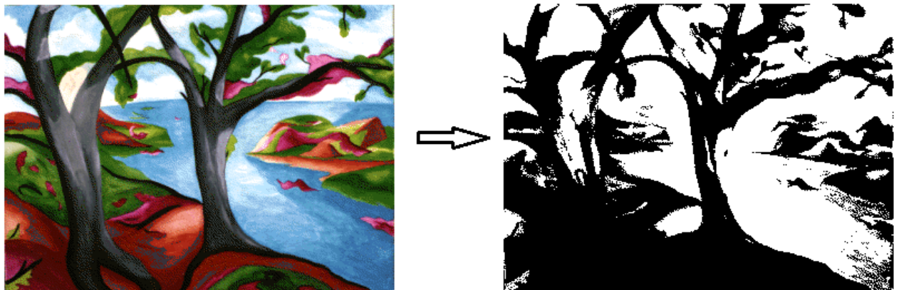
1.16 pav. RGB į juodos ir baltos spalvos vaizdo konversijos pavyzdys
