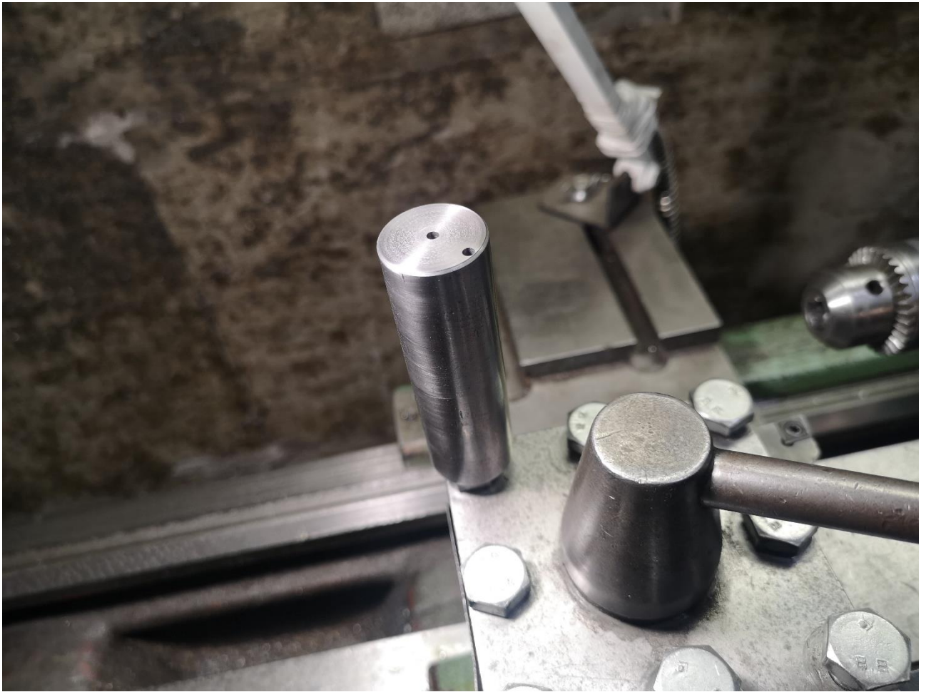
2.2pav. Nušlifuotas metalo paviršius pašalinant nelygumus
