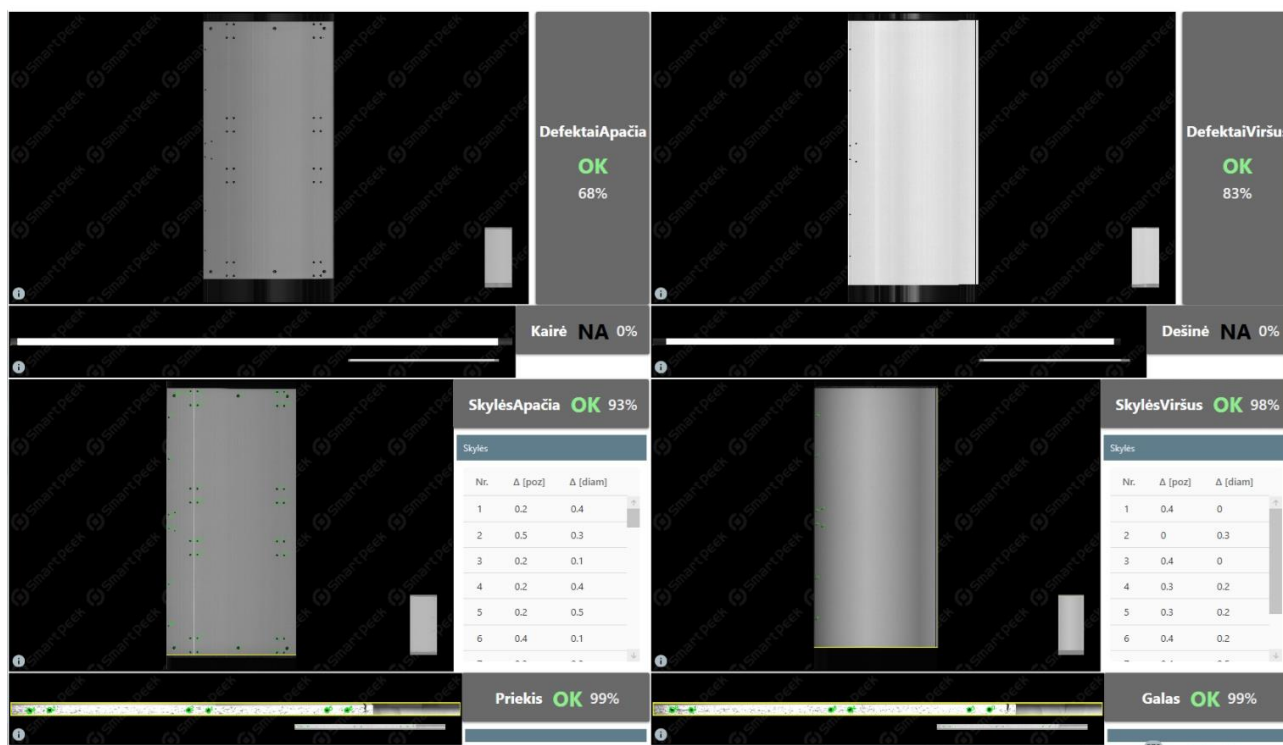
0.2 pav. Paviršiaus defektų patikros sistemos veikimas gamykloje (paviršiaus ir skylių patikra)
