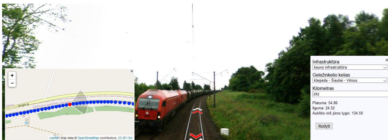
16 pav. Matomumas kreivėje ribojamas reljefo, kai kreivės spindulys 700 metrų. Kauno infrastruktūra, geležinkelio kelias Klaipėda – Šiauliai – Vilnius, 292 – as kilometras
