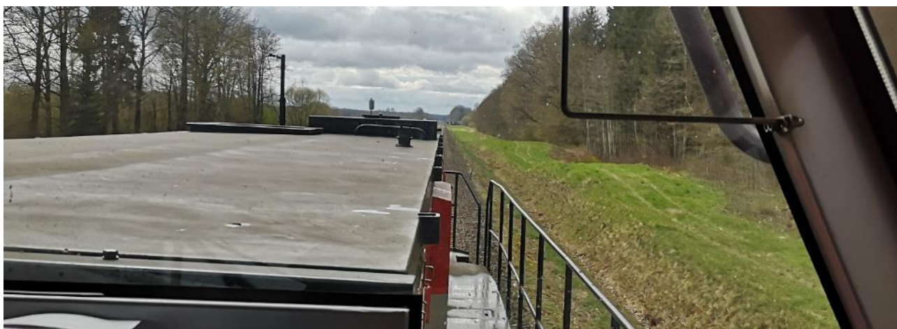
40 pav. TEM TMH 001-011 serijos lokomotyvo matomumas iš mašinisto pozicijos tiesiame kelio ruože
