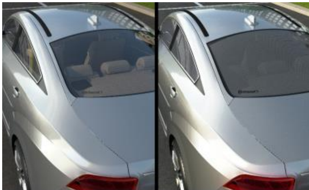
8 pav. Kintamo skaidrumo stiklas [9]
