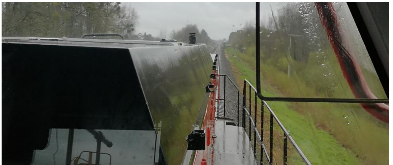
42 pav. TEM TMH serijos nuo 012 lokomotyvo matomumas iš mašinisto pozicijos tiesiame kelio ruože
