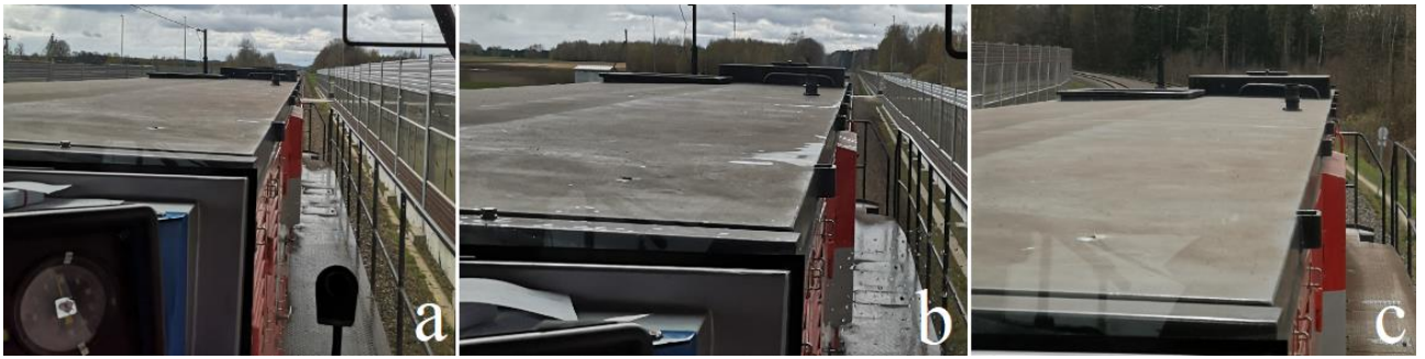
41 pav. TEM TMH 001-011 serijos lokomotyvo matomumas iš mašinisto pozicijos: a – iki pervažos 50m, b – iki pervažos 100 m, c – kreivei sukantis į kairę
