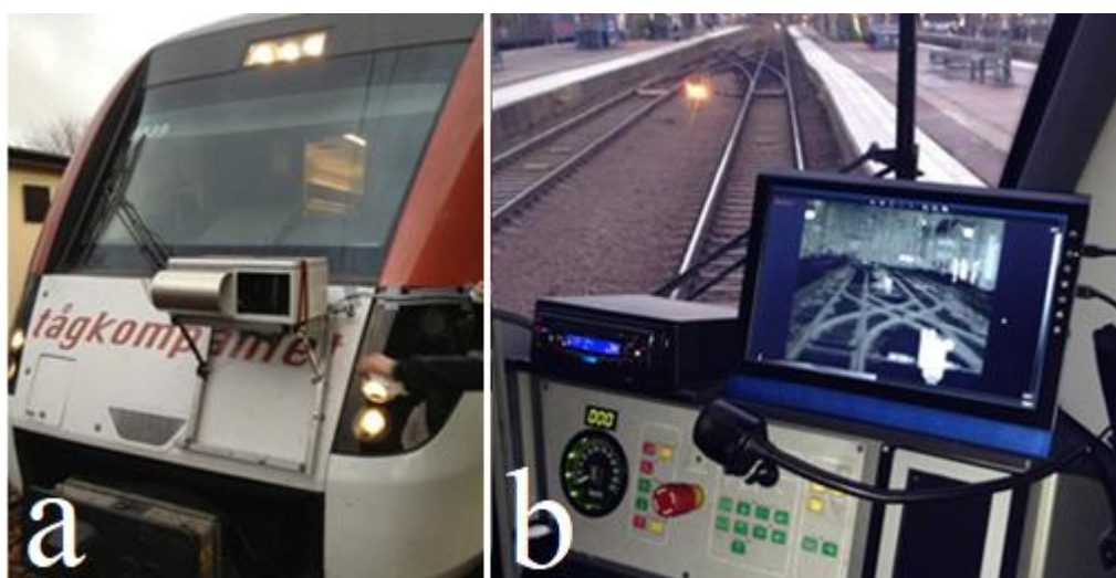
5 pav. Bendras vaizdas: a – traukinio išorėje sumontuota termografinė kamera, b – į monitorių perteikiamas vaizdas mašinisto kabinoje [7]
