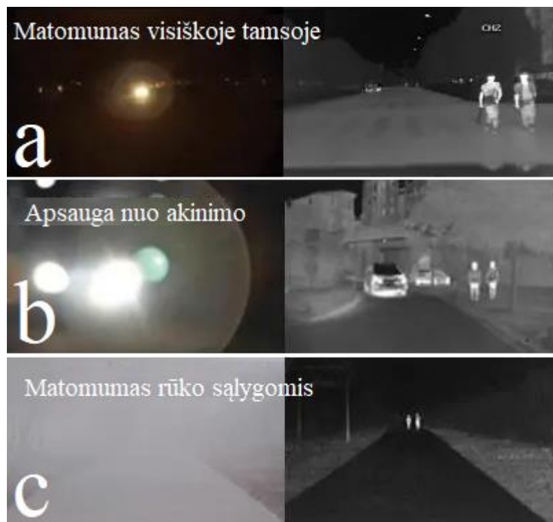
14 pav. Matomumas su termine kamera skirtingomis važiavimo sąlygomis: a – matomumas tamsoje, b – vaizdas akinant kitai transporto priemonei, c – matomumas rūko sąlygomis [14]
