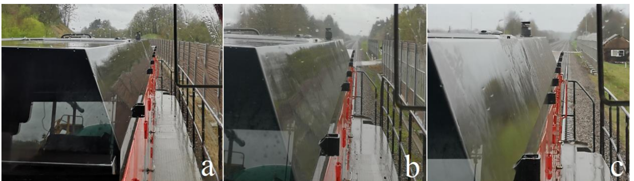
43 pav. Matomumas iš TEM TMH mašinisto pozicijos: a – kreivė į kairę, b – pervažas už 50 m, c – pervažas už 100 m
