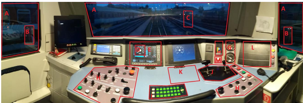
1 pav. Pagrindinės mašinisto kabinos darbo vietos dalys ir dėmesio centrai [3]
