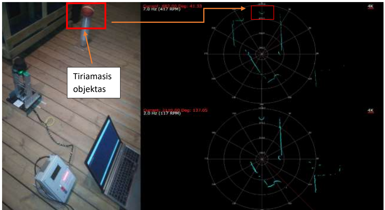
43 pav. Eksperimento Nr. 1 vykdymas (kairėje) ir lokalinio žemėlapio atvaizdavimo pavyzdžiai (dešinėje) prie skirtingų skenavimo dažnių
