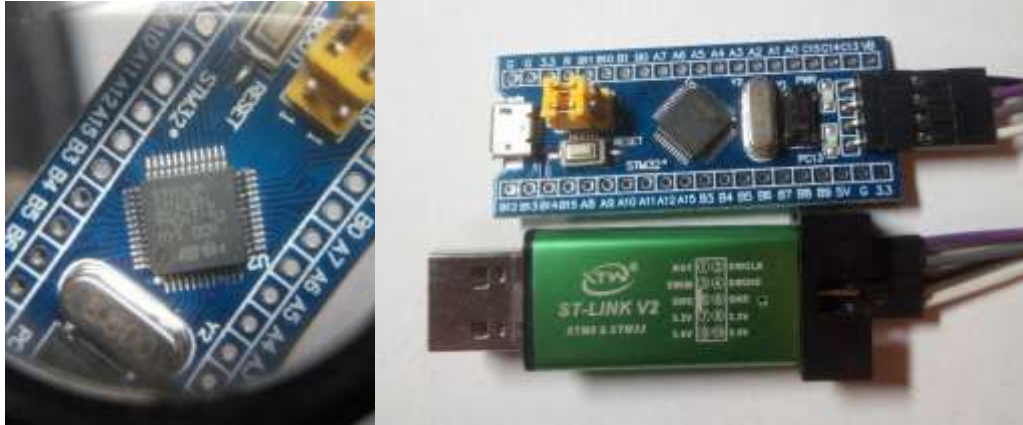
27 pav. Plokštė su integruotu lustu – STM32F103C8T6 mikrovaldikliu ir naudojamas programavimo adapteris STLinkV2
