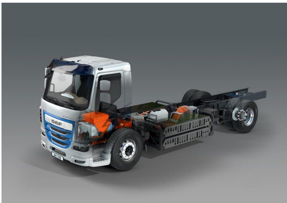
6 pav. „DAF LF“ jėgos pavaros bendras vaizdas vilkike [16]
