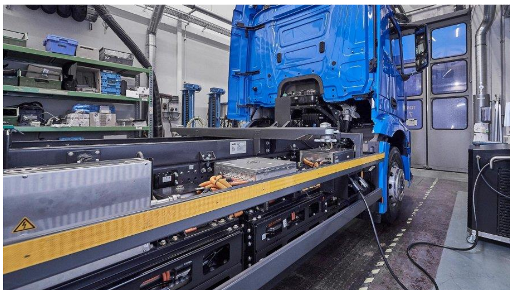
13 pav. „EActros“ akumuliatorių baterijos [27]
