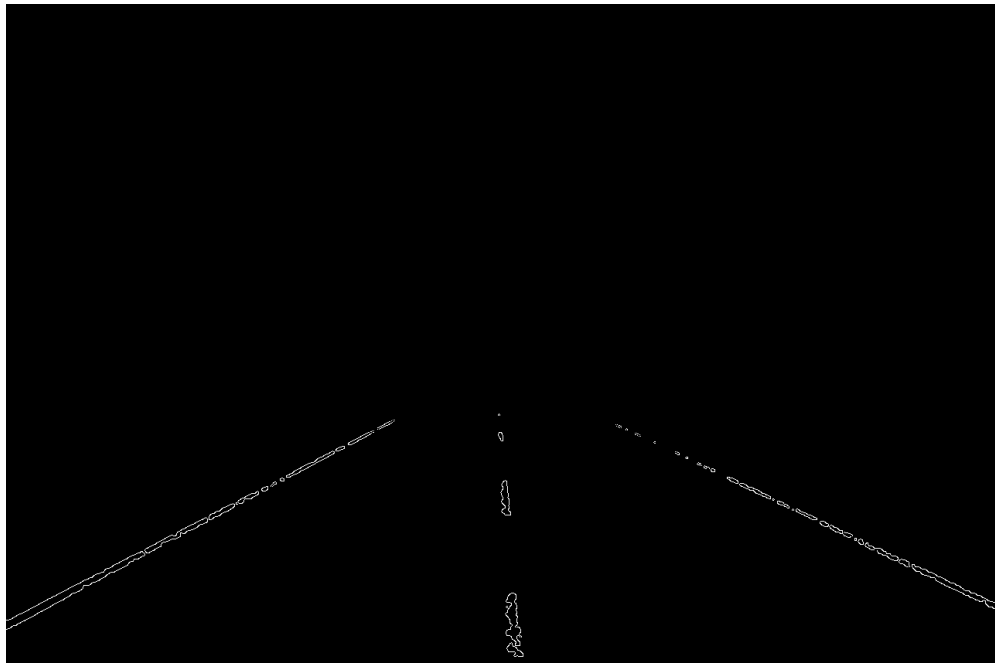
3.13 pav. Canny kraštų aptikimo algoritmas
