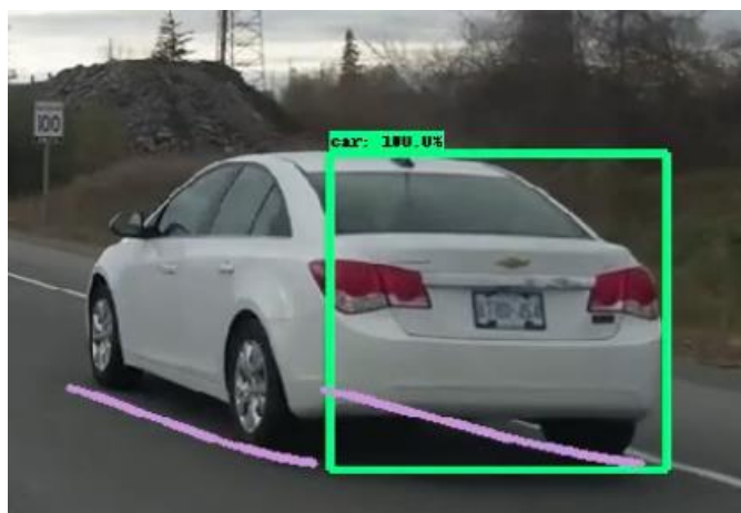
3.4 pav. Trajektorijos skaičiavimas, pažymėjus automobilio priekinę ir galinę dalį
