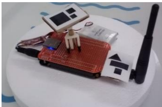
7.5 pav. Mažųjų palydovų bandymų stendas ant vandens pagalvės [110]
