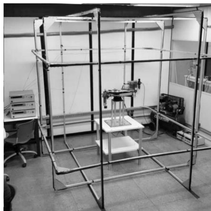
7.2 pav. Helmholtzo rėmas, kurio viduje sumontuota sistema su oro guoliu, skirta palydovų sistemų bandymams atlikti [111]
