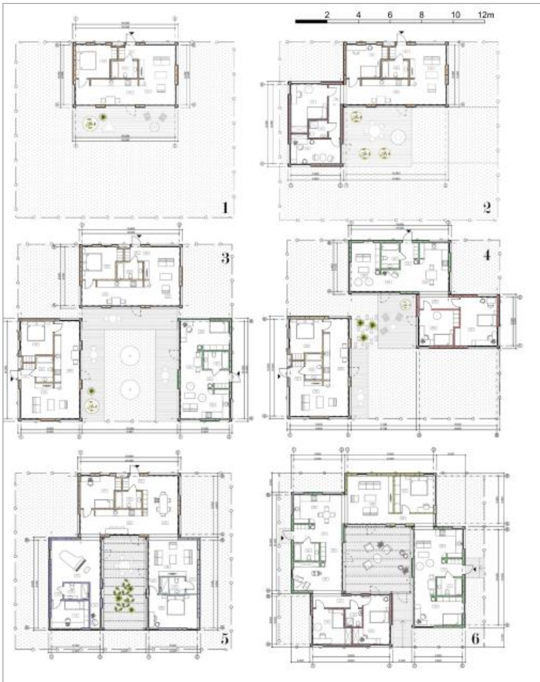
7 pav. Modulinė planinių konfigūracijų planai pagal besikeičiantį asmenų kiekį: 1 – vienam asmeniui (1 modulis); 2 – dviem / trimis priklausomiems asmenims (2 moduliai); 3 nr. – trimis nepriklausomiems asmenims (3 atskiri moduliai); 4 – vienam nepriklausomam ir dviem priklausomiems asmenims (1 atskiras ir 2 sujungti moduliai); 5 – trimis / keturiems priklausomiems asmenims (3 moduliai); 6 – keturiems / šešiams priklausomiems asmenims (4 moduliai). Priklausomi asmenys – asmenys, susieti giminystės ryšiais (pvz. 3–4 asmenų šeima), nepriklausomi – asmenys, neturintys giminystės ryšių (pavyzdžiui, draugai)
