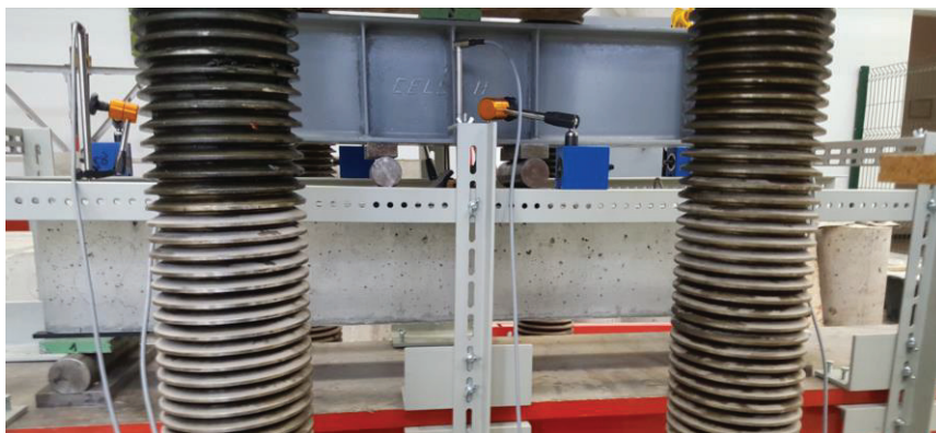
2.3 pav. Gelžbetoninės sijos vaizdas bandymo metu, kai atveriami pradiniai plyšiai
