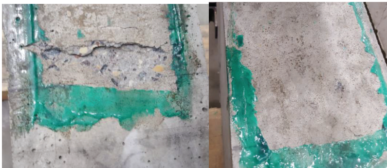
2.8 pav. Betono vaizdas ties anglies plaušo galu po atplyšimo: a) 3 serijos sijos vaizdas; b) 1 ir 2 serijų sijos vaizdas
