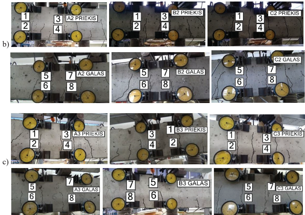
2.11 pav. Kompozitinių sijų plyšiai ir mechaninių poslinkių matuoklių išdėstymas: a) 1 serijos sijų; b) 2 serijos sijų; c) 3 serijos sijų
