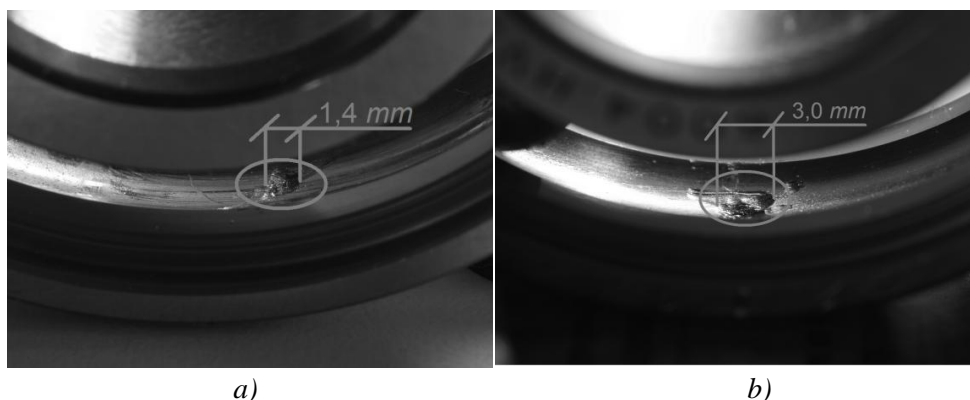
3.32 pav. Tyrimuose naudoti rutuliniai riedėjimo guoliai 6004–2Z/C3 su išorinio žiedo defektais: a) guolis 6004-2Z/C3 su 1,4 mm skersmens defektu; b) guolis 6004-2Z/C3 su 3,0 mm skersmens defektu.
