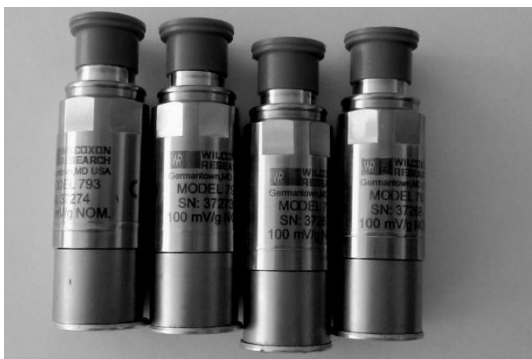
3.33 pav. Tyrimų metu ant rotoriaus atramų sumontuoti pagreičių keitliai: a) pagreičių keitlių montavimo ant atramos schema; b) „Wilcoxon research“ 793 modelio pagreičių keitliai.
