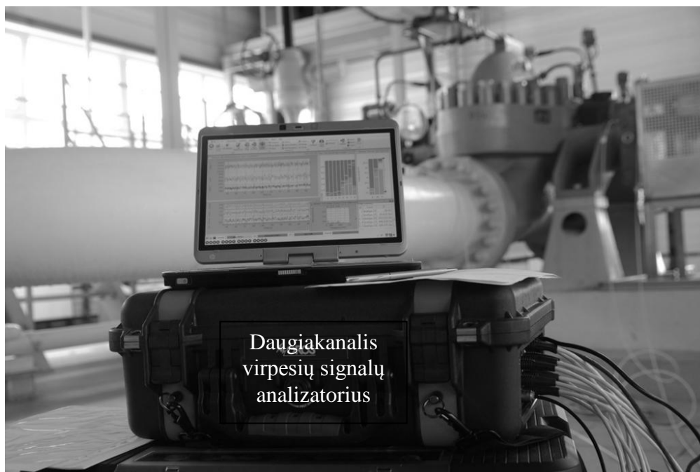
3.34 pav. Daugiakanalis virpesių signalų analizatorius – kaupiklis OROS Mobipack
