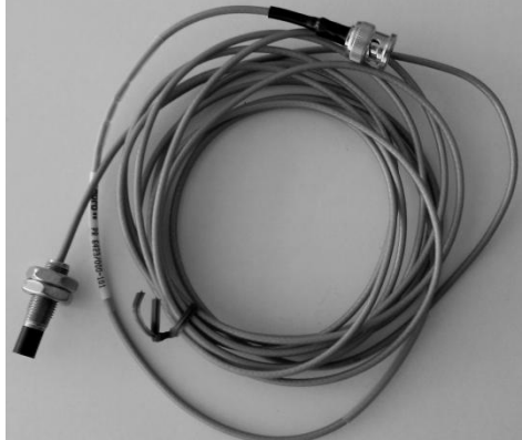
3.35 pav. Poslinkių jutiklis „EPRO“, modelis PR6423
