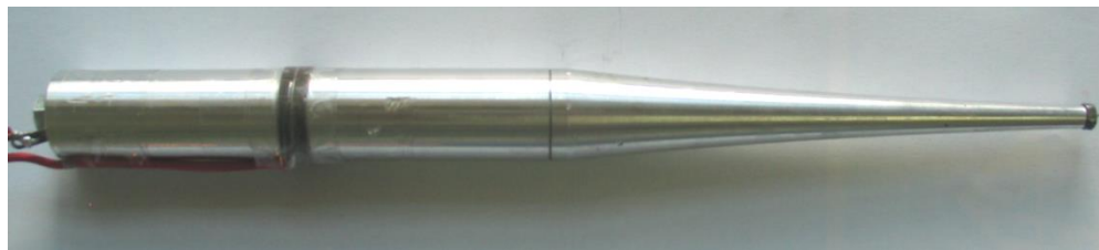
3.6 pav. Eksperimentinis medicininis ultragarsinių virpesių vykdiklis su eksponentiniu koncentratoriumi
