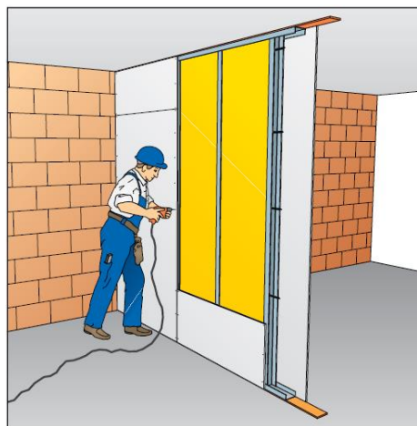
4.9 pav. Gipso plokštės montavimas
