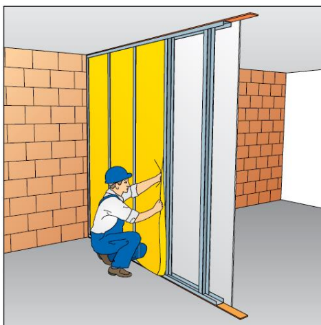
4.8 pav. Mineralinės vatos montavimas
