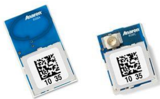
2.1 pav. Kompanijos „Anaren“ gaminami radijo moduliai A110LR09A ir A110LR09C [6]
