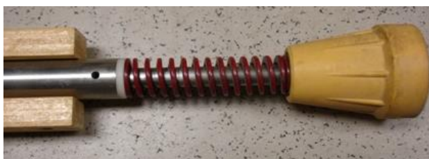
1.1 pav. Spyruoklė sumontuota ramento rėme [2]
