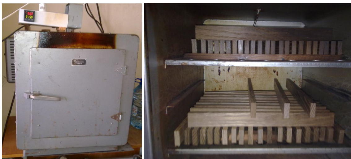
Pav. 2.1. Laboratorinė kaitinimo kamera CH0JI-35.3,5.3,5/3M : kairėje – kaitinimo kameros bendras vaizdas; dešinėje – į kaitinimo kamerą sukrauti bandiniai.
