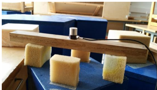
Pav. 2.6. Bandinys ant tampriųjų elementų medienos gaminių tyrimo stende..
