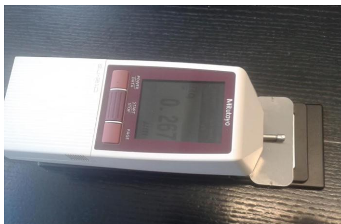
2.5 pav. Mitutoyo SJ-210 matavimo įrenginys su nerūdijančio plieno AISI 304 bandiniu
