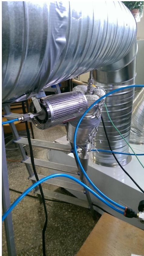
2.34 pav. Dekati DI-2000 skiediklis sumontuotas bandymų stende
