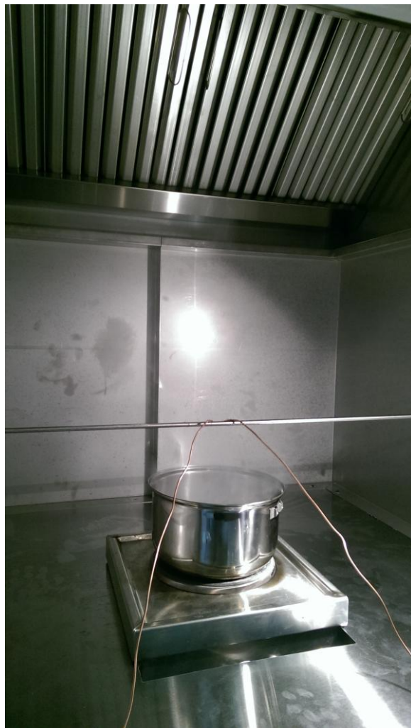
2.37 pav. Eksperimento eiga – į įkaitintą puodą lašinamas distiliuotas vanduo ir aliejus, tuo tarpu garų rinktuvas traukia 1400 m 3 /h debitą
