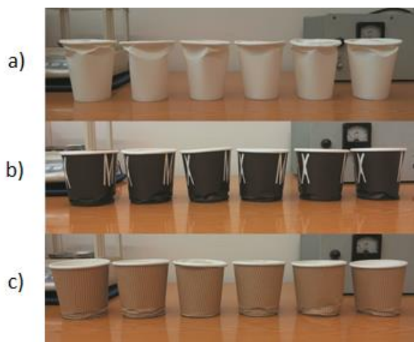
14 pav. Gniuždymo bandymo paveiktų popierinių puodelų vaizdas iš šono, a) vienasluoksniai; b) dvisluoksniai; c) gofruotieji.
