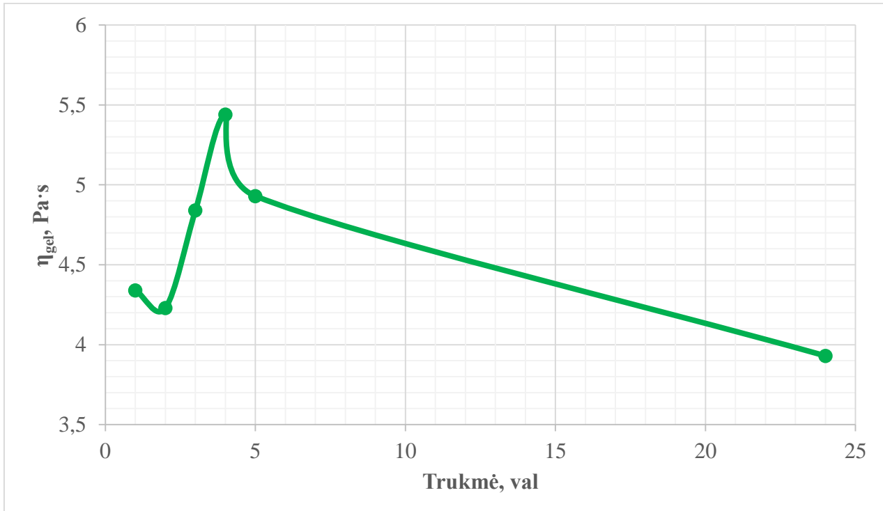
3.9 pav. \eta_{\text{gel}} priklausomybė nuo išlaikymo trukmės reakcijos mišinyje (1 pavyzdys). Reagentų moliniu santykiu - [Kr]:[NaOH];[STMP]:[H 2 O] = [1]:[40];[0,5]:[10], T=45 °C
