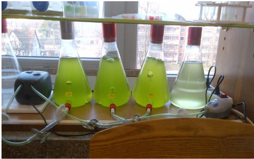
2.1 pav. Chlorella vulgaris dumblių auginimo aparatūra (1 l kolbose)
