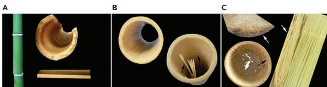
32 Pav. Morfologiniai pokyčiai bambuko stiebelių ir klojėjimosi metu. (A) pradinis etapas, kai bambukas nepažeistas. (B), bambuko pluošto purenimas (C) Pluoštai atskiriant viena nuo kito
